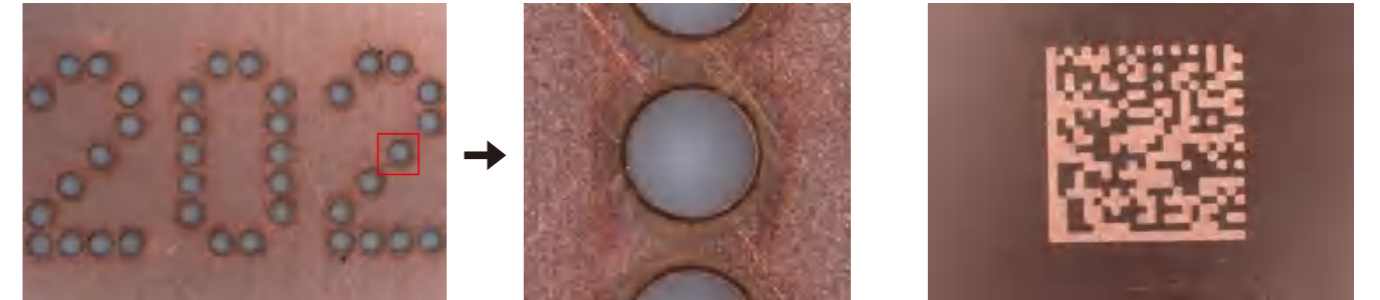
盲孔DM码，深度20μm Blind hole, DM code, 3D, depth 20μm
